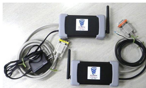
上側が PC 側(AC アダプター付属) 下側が子局のロガー接続用(DC12V 供給)
