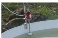
↑蒸発皿と磁歪式水位計
