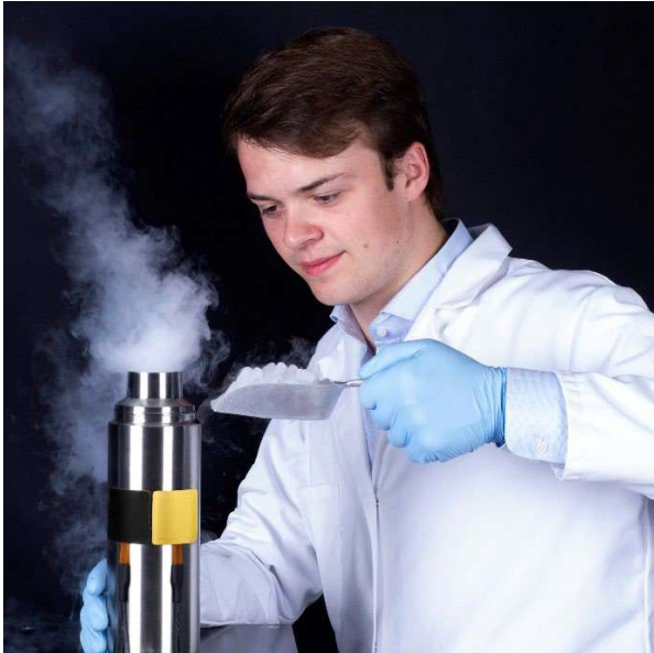
図 7 FHF05-50X50 BLK (黒) GLD (金) ステッカーを使用したサーモスの絶縁ロス計測。
