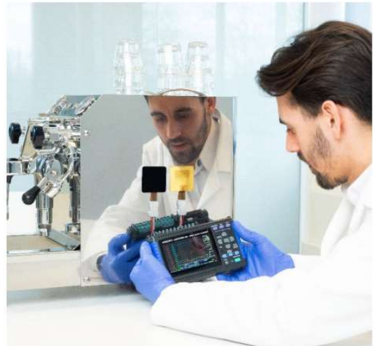
図 8 BLK (黒) GLD- (金) ステッカーモデル。日置電機株式会社LR8432熱流ロガーでの使用例
