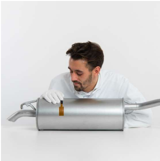
CHF-FHF06 モデルを測定のために車のマフラーに取り付けている様子。センサーは曲面上に取り付けることができます。
