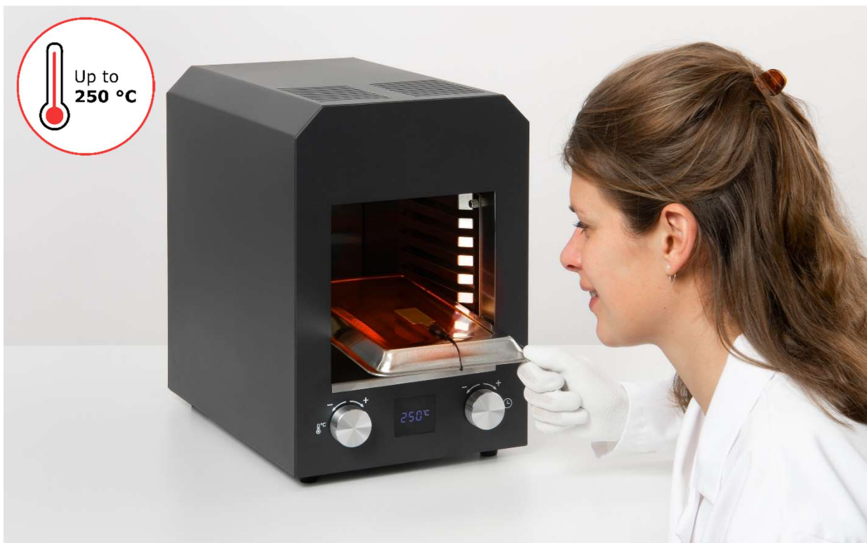
CHF-FHF06 でオーブンのパフォーマンスを測定している様子。250°Cまでの温度下における連続した使用に適しています。
