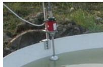
↑ 蒸発皿と磁歪式水位計
