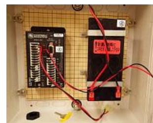
内部は、C-CR300と 鉛電池のみと シンプルな構造
