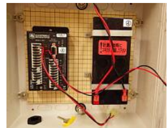
内部は、C-CR300 と鉛電池のみとシンプルな構造
