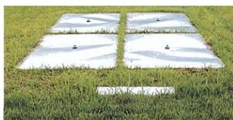
メタルウェファーは米国カリフォルニア州の資源局(Resources Agency)に於いて1974年に開発された積雪重量計測装置で、1983年我が国に於いて電気的な記録ができるように改良され、北陸地方の積雪に対して実用性が確かめられました。本製品は新規に開発した各種表示装置及び警報装置をメタルウェファー本体と組み合わせ、システム化したものです。
