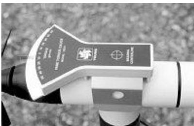
風向計ベアリングの起動トルクを測定することができます。
