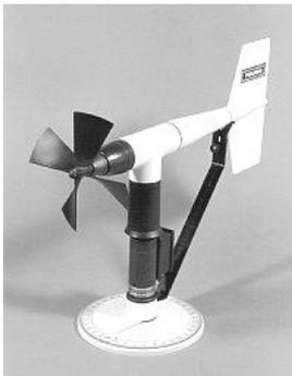
この円盤に風速計をのせて、風向出力の校正を行います。1度単位の校正を行うことができます。
