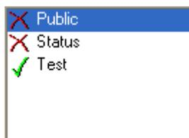
接続したロガー内のプログラムで使用しているデータテーブルが表示されます。使用しているデータテーブルの内、Collect を行ったときにデータを回収するテーブルは緑のチェックマークが、回収しないテーブルは赤い×印が付きます。
