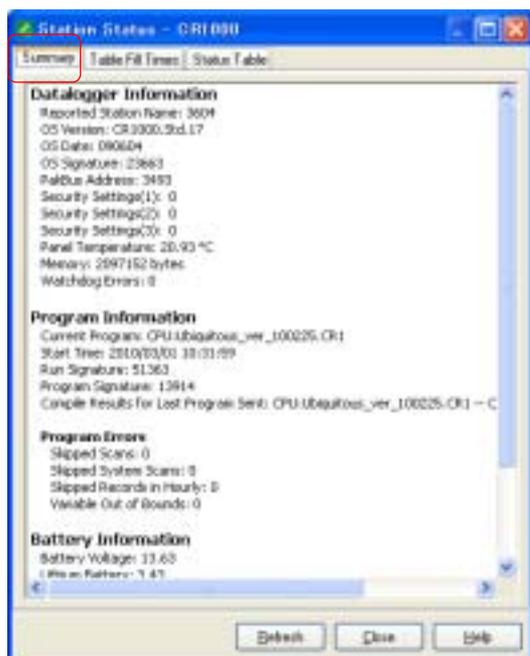
Summary タブはデータロガーの重要な状況情報を表示します。データロガーのモデル名、ファームウェア、プログラムの詳細、プログラムエラー、バッテリー電圧レベル、およびメモ리카ードの情報を含んでいます。このウィンドウ内で右クリックすると、概要を印刷するか、またはファイルにこの情報を保存する事ができるメニューが表示されます。
