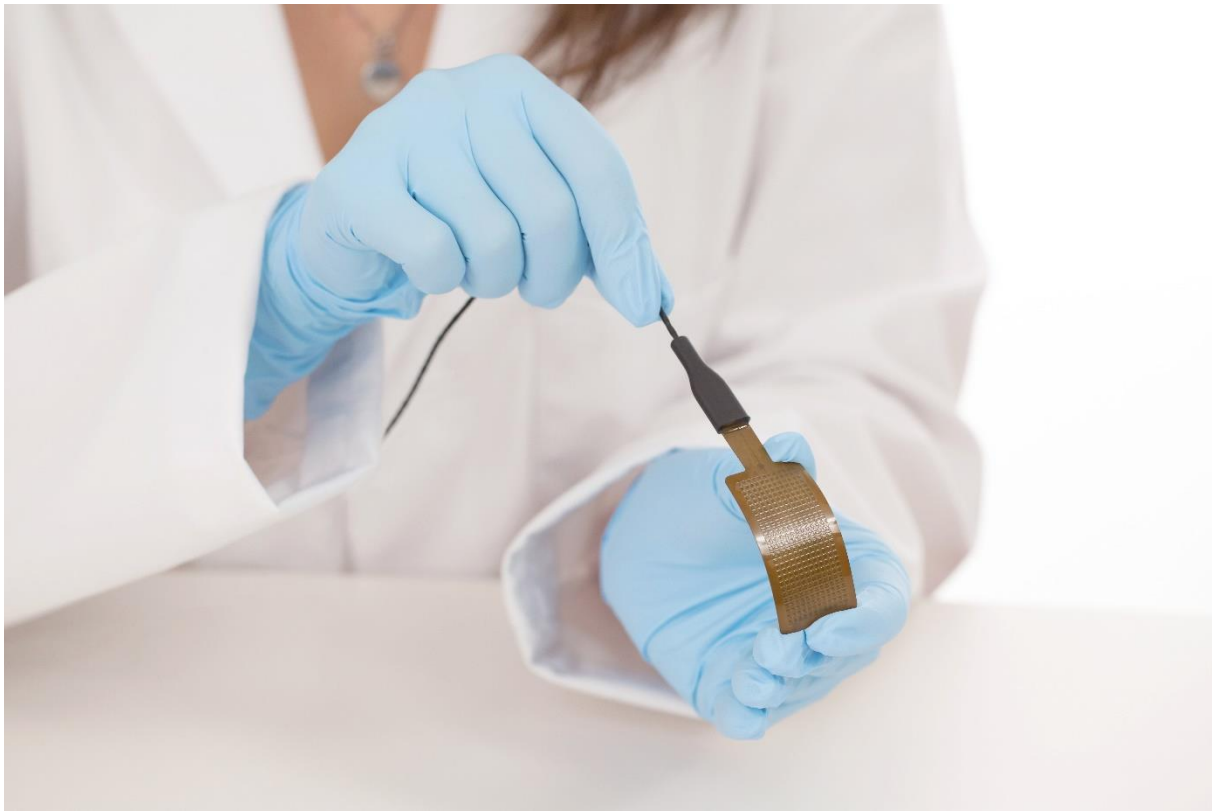
図2.2 裏面から表面への熱流束により、プラスの電圧出力信号が発生します。薄膜上のドットが、表側を示す表面表示になります。
