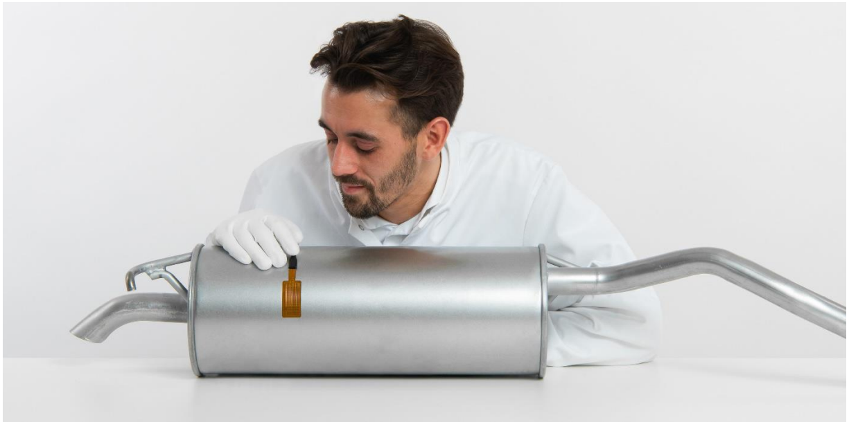
図 4.1.1 CHF-FHF06モデルを測定のために車のマフラーに取り付けている例。FHF06はパイプ等の曲面上に簡単に取り付けすることができます。
