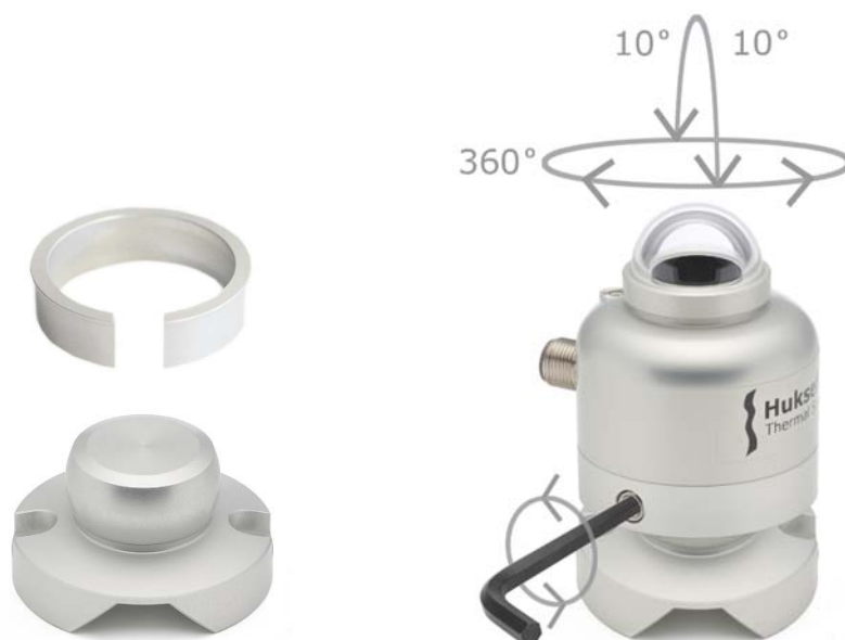
Figure 5.4.1 左下は SR05 のボールレベリング、左上はシム、右は SR05 にボールレベリングを装着した例です。皿ネジを緩めてから向きを調整します。4mm の 6 角レンチが必要です。
