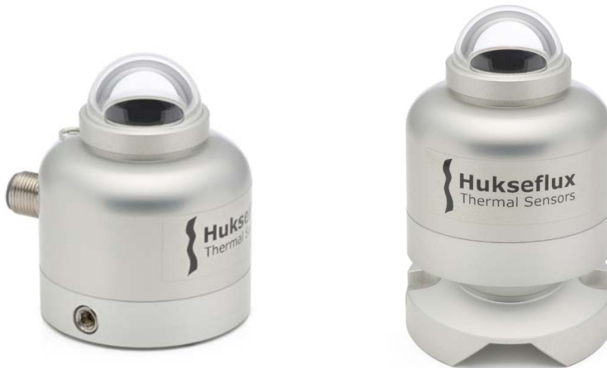
Figure 0.1 左の水準器、M12-A ケーブルコネクタ付き SR05 デジタルセカンドクラス日射計は標準的な仕様です(3m ケーブルが標準で付属します)。右のボールレベリング付きは据え付けと(非)水平面調整が容易な仕様です。
