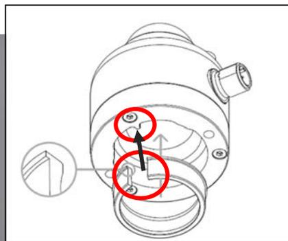
5. シムの向きに気を付けながら日射計に取り付ける
