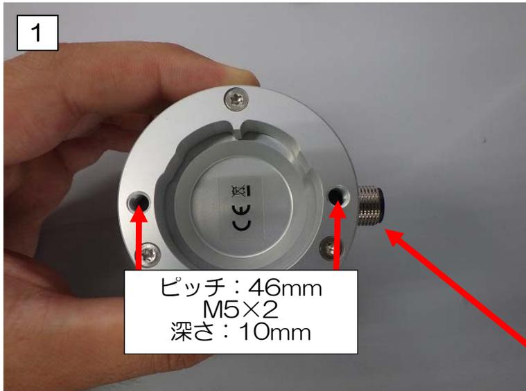
1. 日射計裏側の取り付け穴と設置する水平台の取り付け穴のピッチが合うことを確認
