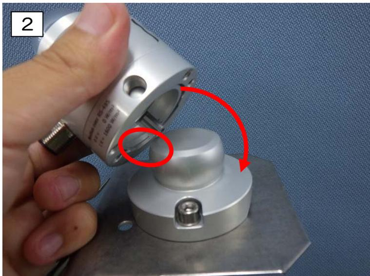
2. ボールレベリングの角と本体下部を合わせて差し込み、日射計(シム付)をボールレベリングに取り付ける
