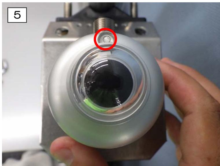
5. ボールレベルリングを用いた取付方法と同様に日射計を取り付け、水準を合わせる
