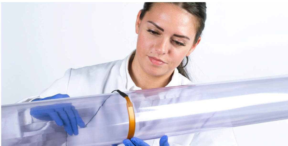
図 0.2 パイプの熱流束を測定するために薄膜熱流センサ CHF-FHF05-15X85(LGサイズ) を取り付ける様子
