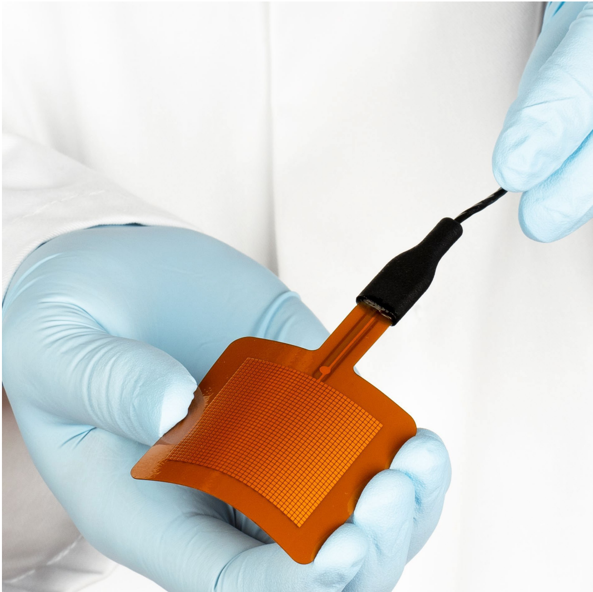
図2.2 裏面から表面への熱流束により、プラスの電圧出力信号が発生します。薄膜上のドットが、表側を示す表面表示になります。
