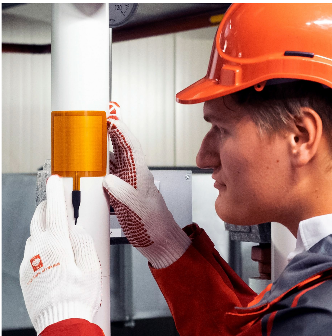
図 4.1.1 CHF-FHF05-85X85モデル(Lサイズ)を産業用配管計測のために取り付けている例。センサは曲面上に取り付けられています。
