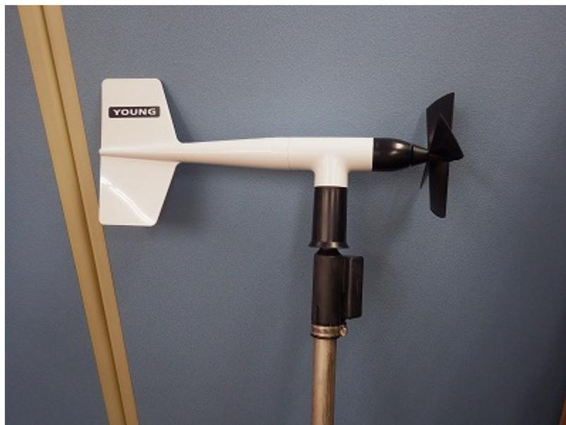
φ34mm のパイプに本体を差込んで下さい。約 8cm 差し込めます。差込みが短いと強風等で脱落する恐れがあります。パイプ頂部から約 8cm の所に目印を付ける等して、必ずしっかり差し込んで下さい。
