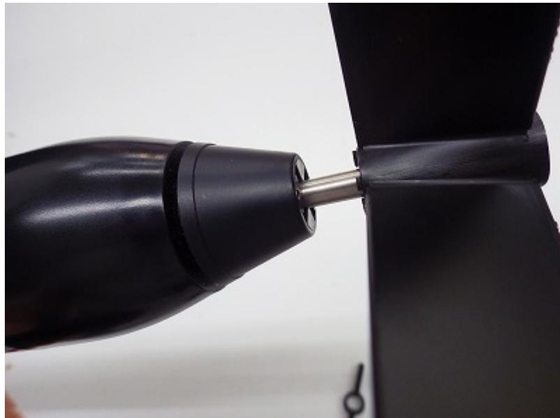
次に、赤丸部分を手で押さえながら、プロペラナットを専用レンチでしっかりと締め付けます。
