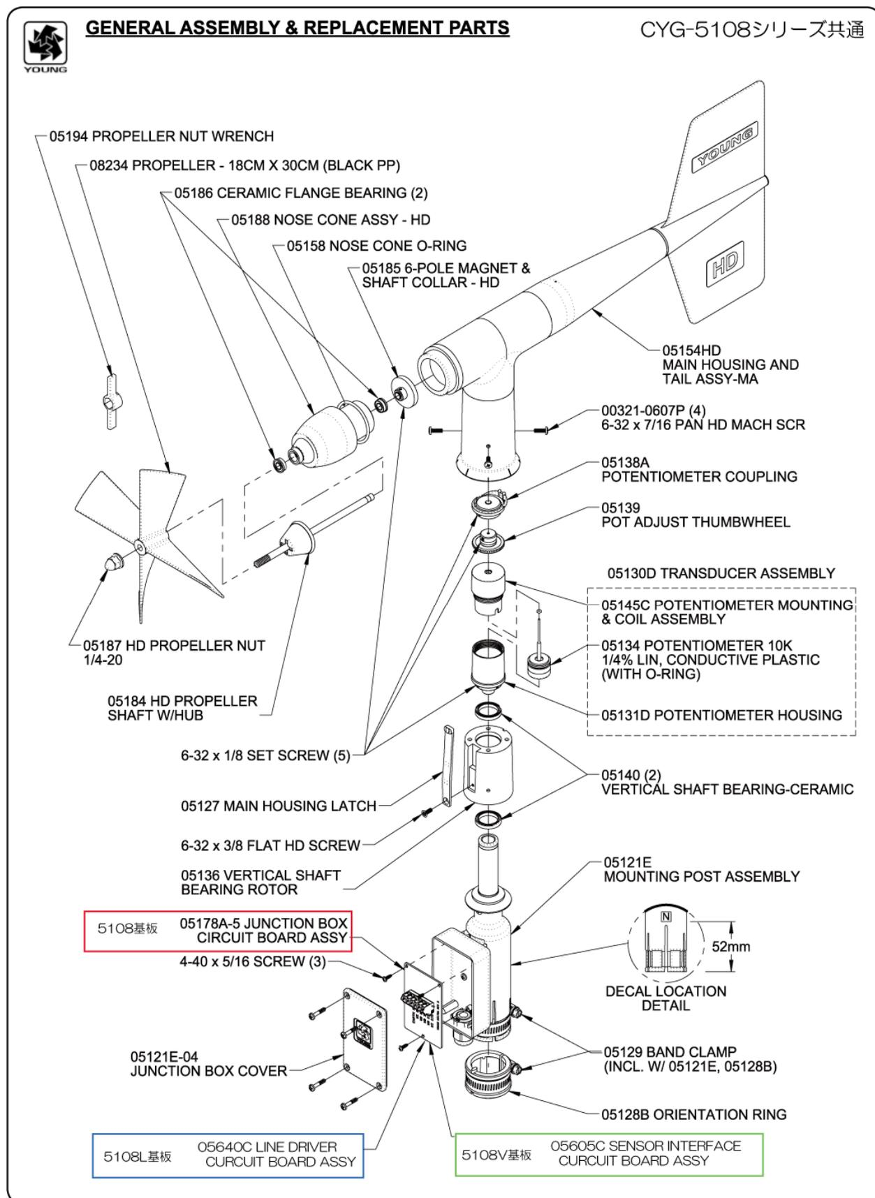
\*CYG-5108LM 基板 05640BM LINE DRIVER CIRCUIT BOARD ASSY (M/S)
